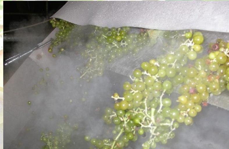
Uva all' uscita del tunnel di crioestrazione
